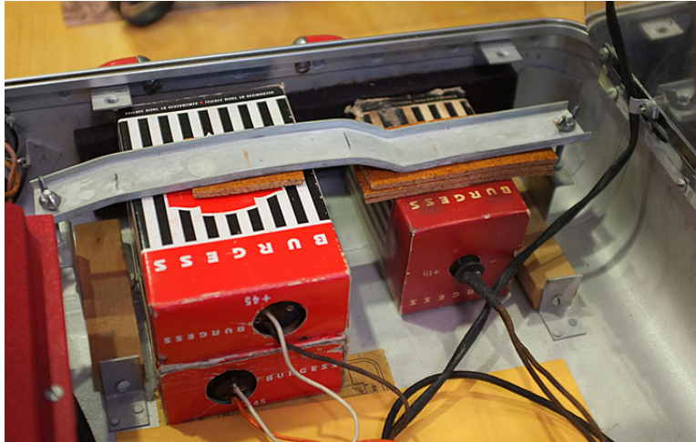
45 volt x 2 B batteries + 1.5 volt A Battery, 3 connectors
